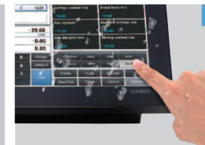
5 L'écran tactile est conforme au standard de résistance IPX2 et peut être utilisé même avec des mains humides.
