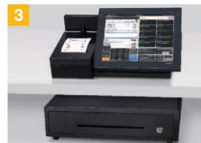
3 Le tiroir en option peut être installé à l'écart du terminal, ce qui permet une disposition plus flexible.
